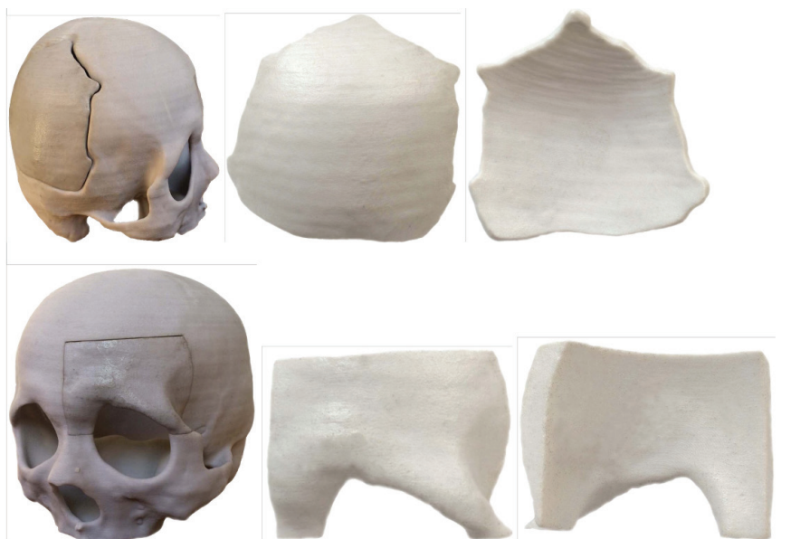
Рисунок 9 – Изготовление имплантата из биоцемента на основе полиметилметакрилата
